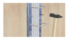
Fixation au coffrage: enfoncer les clous à travers de la perforation.
