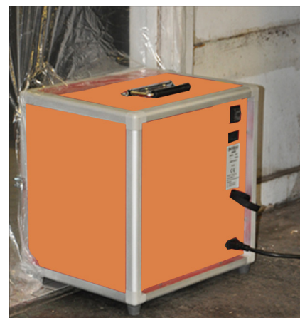
Dual-Signalleuchten: oranges Licht zeigt verstopften Filter, rotes Licht zeigt Leckage in HEPA-Filter. Akustischer Alarm bei verstopften oder defekten Filter.
